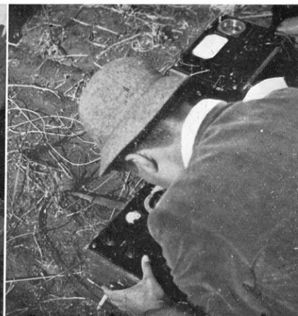
帯水層調査のための電気探査
