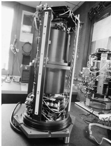
写真4 スクリプス海洋研究所が開発した海底重力計の1つのユニットの内部。CG3M重力計を使用したものもCG5重力計を使用したものも同形。一番底に水圧計が装着してある。
