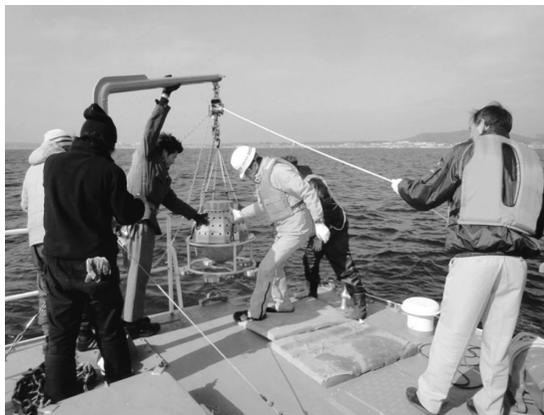
写真7 調査地点で海底重力計を海底に降ろす作業。
