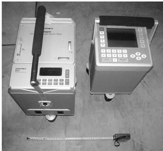
写真5 陸上用可搬型重力計、CG3M重力計(左)とCG5重力計(右)。
