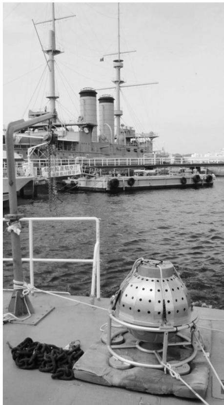
写真6 調査船ヴェルニーⅢ号の甲板に固定した海底重力計。後に見えるのはZ旗を掲げた戦艦三笠。
