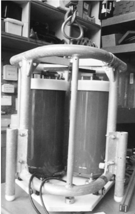
写真2 スクリプス海洋研究所が開発した海底重力計の外観。3台の重力計ユニットが組み込まれている。
