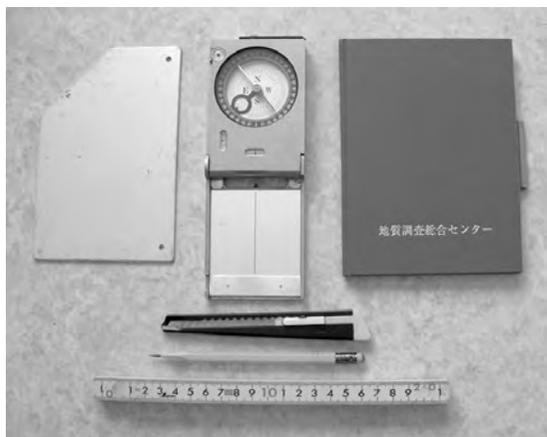
第14図 野外でのルートマップ作成作業に必要な小道具類。上段は、左から、走向板、クリノメータ、野帳、クリノメータは、シンプルな木製タイプのものでもかまわない。この他に、露頭表面を削ったり層理面を出したりする堆積用ピックルなども必要である。
