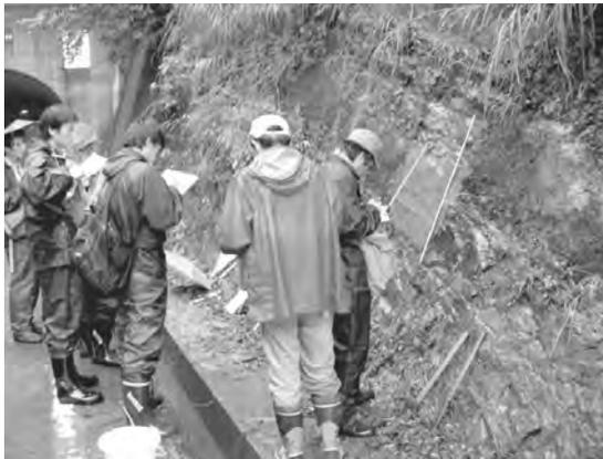
第12図 雨の日の地層断面上の堆積構造の観察風景。堆積用ピックル、たわし、バケツで汲んだ水などを使って、厚さ1m前後のタービダイト砂岩断面の堆積構造を浮かび出した後、観察しながらスケッチをしている。清和県民の森の林道澗ヶ沢支線の澗ヶ沢トンネル横。2009年10月。
