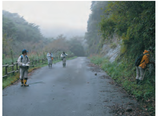
d. 進行方向をクリノメータで、距離を歩測(複歩)してルート図を作成しながら、ときどき層理面も測ってルートマップを完成させていく。2008年10月。
