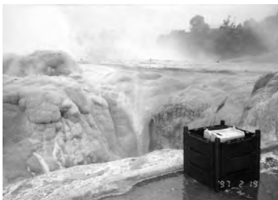
写真2 テホル湯溜りのすぐ横に設置したCG3M重力計。
