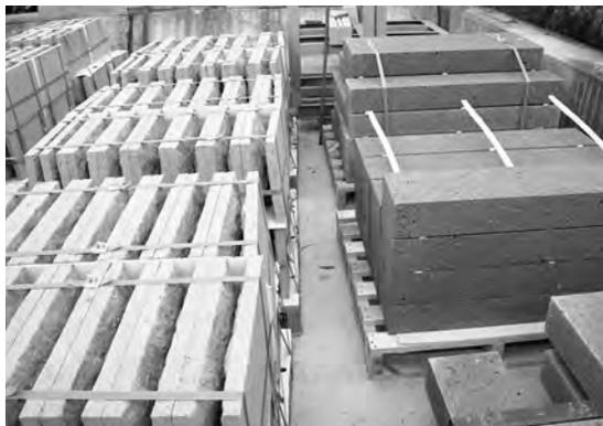
写真15 出荷を待つ福光石. 電動鋸で採掘後, 切断・研磨されて出荷を待ちます.
