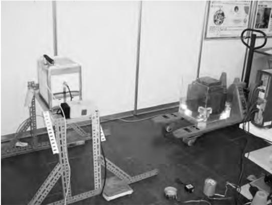
写真1 2008年における実験の様子。左側の金属フレーム台と台上の重力計（シントレックス社CG-3M型）が重力測定部で、赤いハンドパレットとその上の黒っぽい金属塊が移動式鉛重錘部。右端にわずかに写るコンピュータが測定結果表示部。
