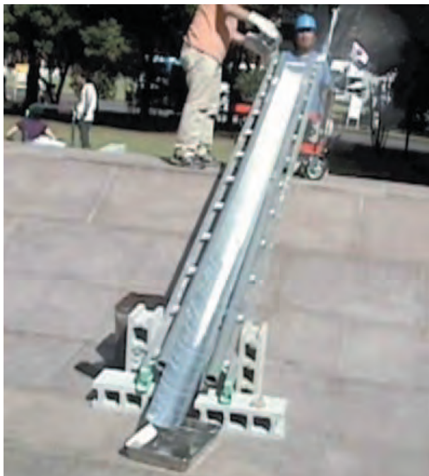
右: 熱した砂と重曹による人工火砕流の様子。立ち上がる白煙も工夫の一つです。
