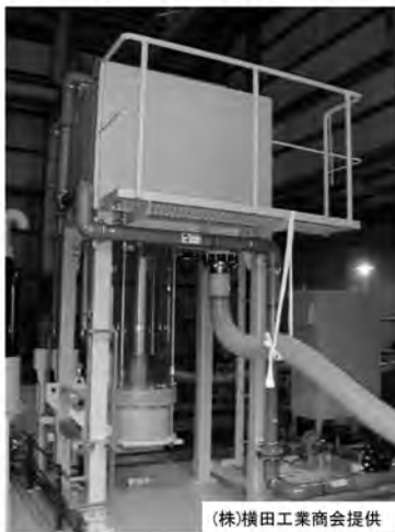
第11図 浮体式吸着装置と流動床式カラム吸着装置。
