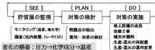
第4図 地熱貯留層管理の目的とフロー。
