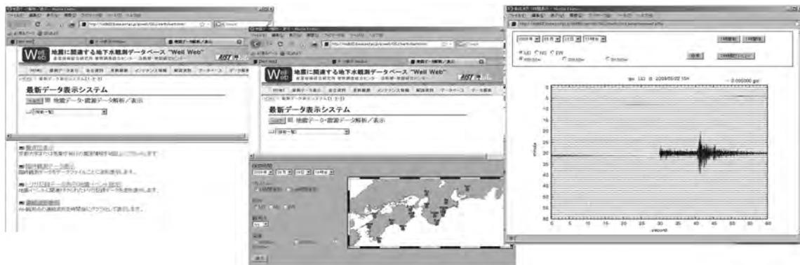
第4図 地震データ・震源データ解析／表示画面の表示の例。(左)：地震データ・震源データ解析／表示の選択画面。(中)：連続波形表示の選択画面。(右)：連続波形データの表示例。
