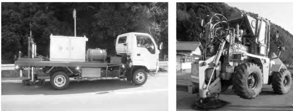
第2図 反射法地震探査で使用した震源装置. 左:ミニバイブ (Mini-Vib T15000, IVI社製), 右:油圧インパクト (Impactor JMI-200, 地球科学総合研究所製).
