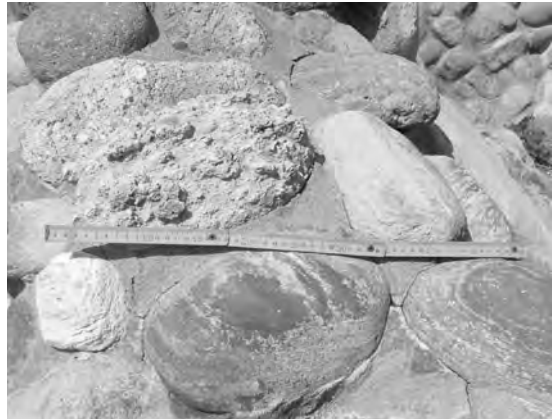
第24図 玉石とその風化状況。スケール上方の著しく風化・侵食された礫は火山礫凝灰岩，その下方の縞目のある礫は結晶質の流紋岩。
