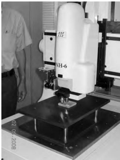
写真2 礫の表面状態の観察に用いた、三鷹光器製 NH6型非接触三次元測定装置(名古屋大学技術部)。
