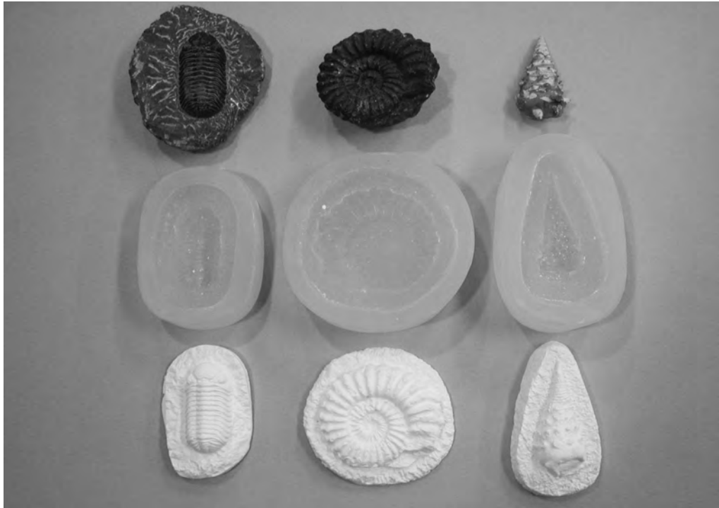
第3図 当館の化石レプリカ。上段：化石，中段：シリコン型，下段：レプリカ。
