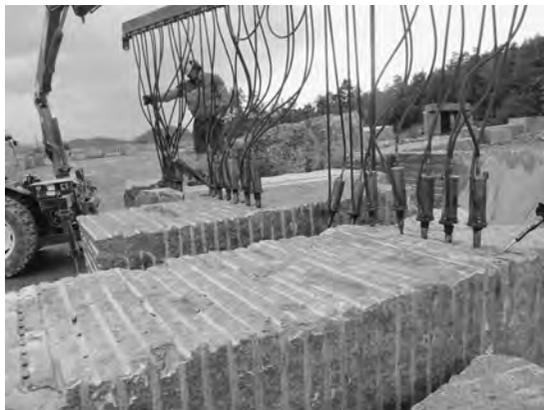
写真14 ラルピカイトのブロック切断作業。
