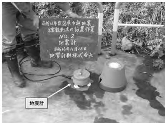
写真2 地震計の設置。地震計の脚は石膏で固定し動かないようにする。また、雨や風によるノイズ対策のため、地震計の横に置いてある植木鉢を地震計の上に被せた。
