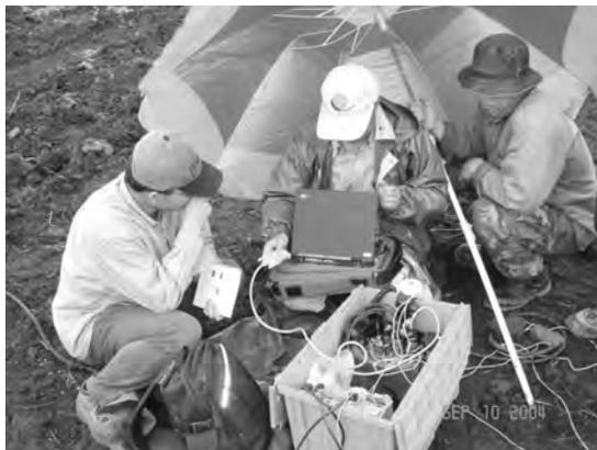
写真5 測定装置のセットアップ. MT法では夕方から翌朝までの自動測定を行うが, そのためのパラメーター設定を行う.
