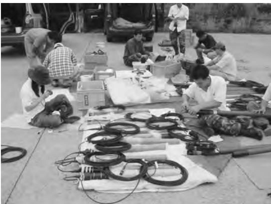
写真1 測定装置(磁場センサー, 電極等)の準備作業。
