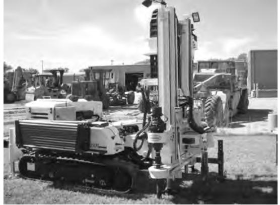
写真2 デモで使用したジオプローブ社の6625CPT試験装置。
