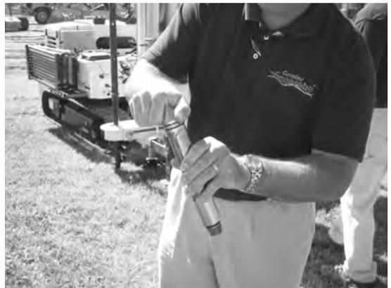
写真3 Geotech社の無線電送型ワイヤレスコーン。
