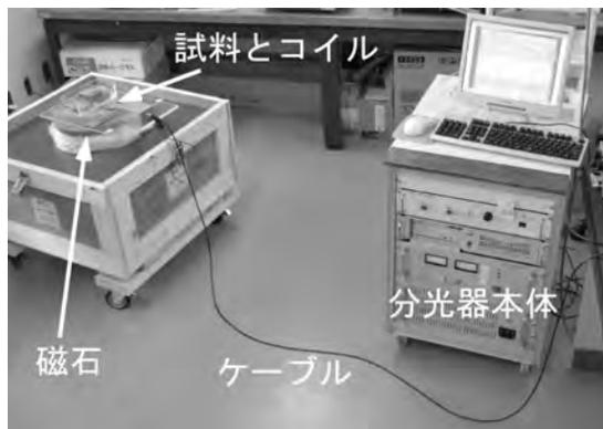
第6図 物理探査研究グループで開発中の核磁気共鳴表面スキャナー(プロトタイプ)。センサー部分(希土類磁石とコイル)と分光器本体を黒いBNCケーブルで接続しています。コイルの上にはテスト用試料が置いてあります。
