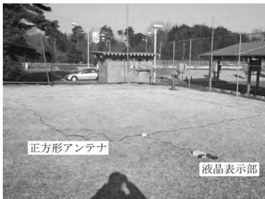
第5図 産総研つくば構内での、2kHz付近の電磁波のバックグラウンドノイズ強度の計測風景。一辺が6.25mの正方形の微小ループアンテナ(20巻き)に誘起される電圧を計測しました。なお、アンテナ工学において、「微小」とは、電磁波の波長(2kHzなら150km)に比して、アンテナサイズ(6.25m)が桁違いに小さいことを意味します。
