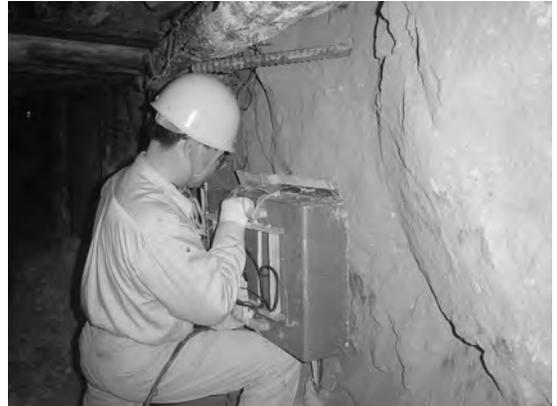
写真2 地中レーダのアンテナを坑壁にしっかりと押さえつけている様子。
