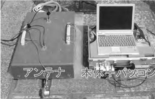
写真1 使用した地中レーダ装置の外観。
