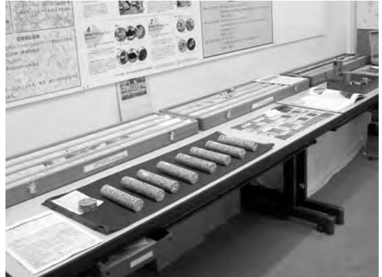
第12図 万成花崗岩の笛(手前)と調査ボーリングで採取した深部(500以深)コアや岩石試験での供試体を展示。
