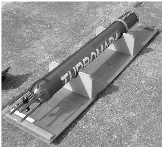
写真1 自由浮上型海洋鉛直微細構造測定装置。
