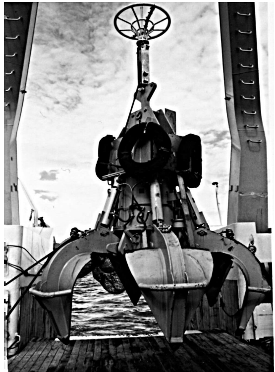
写真2 底質採集に用いられたファインダー付パワーグラブ。
