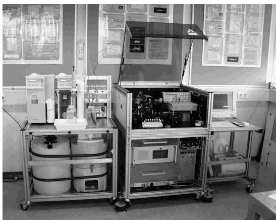
第1図 可搬型のレーザー誘起ブレイクダウン検出法(LIBD)システムの外観(Hauser et al. , 2002; Elsevier社の許可を得て転載)。
