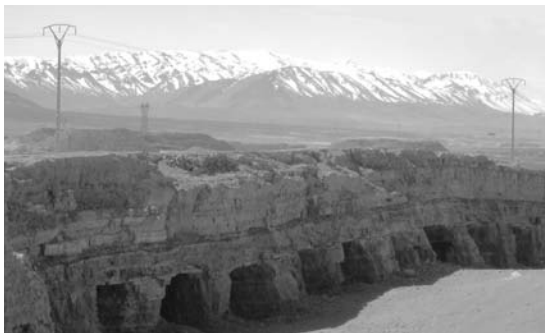
第4図 ミブラデン鉱山の採掘跡。露天掘りの中央部から坑道が放射状に延びている。背後のハイアトラス山地の頂部には残雪が残っている。
