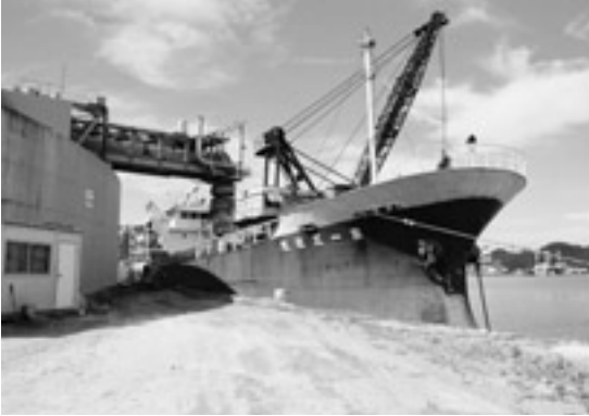
写真8 砕砂の船による出荷。ベルト・コンベアで岸壁に運ばれた砕砂は、コンピュータで制御されたシップ・ローダーで自動的に積み込まれる。
