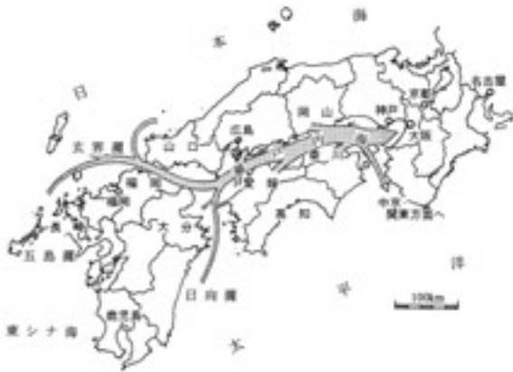
第2図 砂の道「瀬戸内サンドロード」。1992年頃の西日本における砂の供給の流れを概念的に表示したものである。
