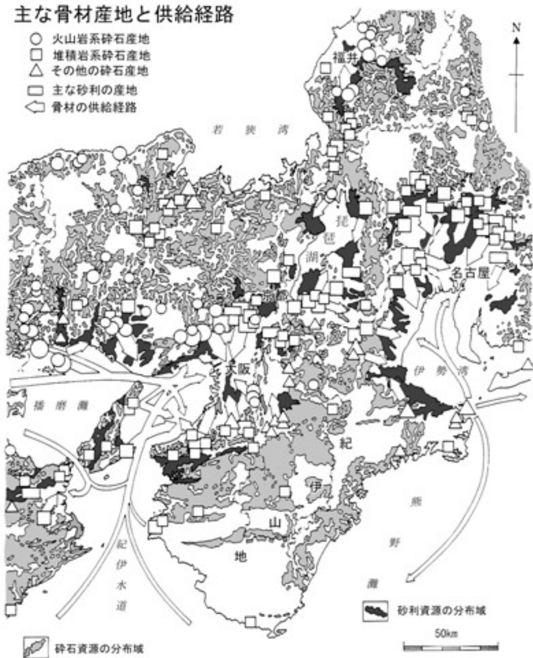
第3図 近畿地方における砂利需給. 1990年頃の骨材の産地と供給経路を概念的に示したもの. 産地を示す記号は, その生産量により概ね3段階に表示した.
