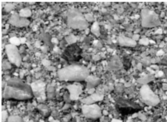
写真3 城陽市産の砂の画像(画面の左右が2.8cm)。石英・頁岩・砂岩・チャートなどの粒子からなる。
