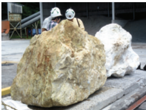
4. 菱刈鉱山の鉱石標本。左側は、山田鉱床70~50mL採鉱W150B友泉6-2脈から採取され、重さ約4t, Au 約40g/t。撮影場所は菱刈鉱山山田坑口前。2001.6.18.撮影。鹿児島大学総合研究博物館に寄贈されている日本最大の高品位金鉱石標本。
