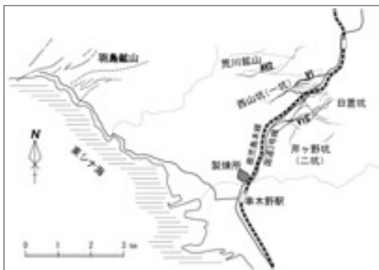
第1図 串木野鉾山各坑分布図。JR串木野駅から北へ向い、製煉所は0.5km、西山坑・芹ヶ野坑は3~5kmに位置する。その北西の荒川鉾山、西の羽島鉾山と併せて広義の串木野鉾山と称する。
