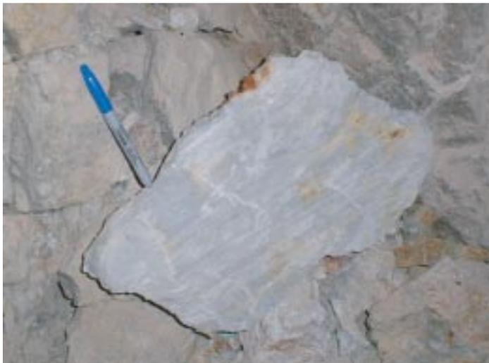
3. 崩落した断層面上に確認される明瞭なslickenside.
