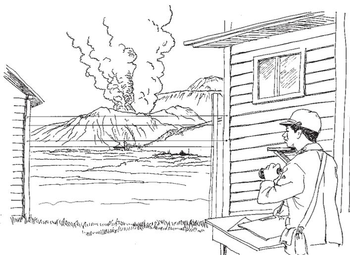
第2図 創意工夫による簡易定点観測法。目線が一定になるように顎を載せる台を固定、水平にテグス糸を張って基準とした。
