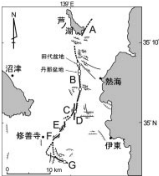
第3図 北伊豆断層帯の活断層と1930年北伊豆地震の地表地震断層の分布。太線は宇佐美(2003)に示された1930年の地震断層の分布を、灰色の線は活断層研究会(1991)によって示されている。北伊豆断層帯以外の活断層を、白丸印はトレンチ調査が実施された地点をそれぞれ示す。A: 箱根町断層, B: 丹那断層, C: 浮橋西方断層, D: 浮橋中央断層, E: 大野断層, F: 加殿断層, G: 姫之湯断層。
