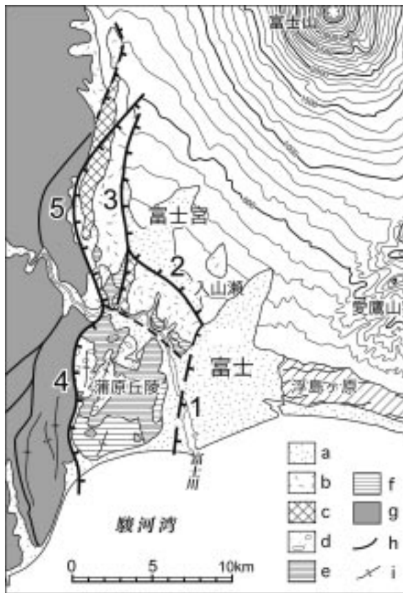
第5図 富士川河口断層帯とその周辺の地形・地質(Yamazaki et al., 2002に加筆). 1: 入山瀬断層, 2: 大宮断層, 3: 安居山断層, 4: 入山衝上断層, 5: 芝川断層. a: 沖積層, b: 古富士泥流, c: 富士溶岩, d: 鷺の田礫層, e: 岩淵安山岩, f: 蒲原礫層, g: 先第四系, h: 地質断層, i: 褶曲軸.
