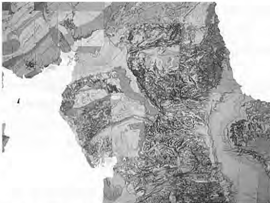
第4図 英国のデジタル地質図(出力図：部分), 5万分の1の区画ごとに精度が極端に異なり, 地層区分も連続していない。
