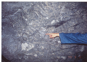
8. コチャブラク多金属鉱床の高鉱部。ほぼ硫化物のみ、角礫構造が顕著な礫状鉱(左)と塊状鉱(右)。1,200m坑、57斜坑。
