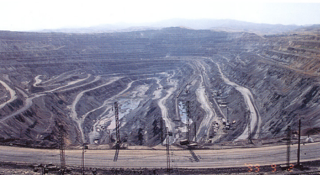
9. カルマキル ポーフイー銅鉱床のオープン・ビット、一日約7万トンの銅鉱石を採掘。
