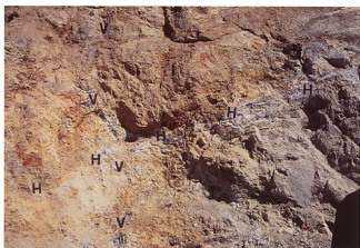
7. コチャブラク多金属鉱床オープン・ビットに見られる縦(V)と横(H)脈の関係。ここでは鉱石は着かず、変質割れ目のみ産出。
