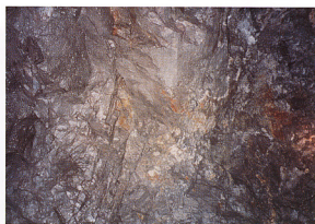
8. コチャブラク多金属鉱床の高鉱部。ほぼ硫化物のみ、角礫構造が顕著な礫状鉱(左)と塊状鉱(右)。1,200m坑、57斜坑。
