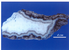
17. 細粒白色石英(切断面)。微粒の白色石英塊を包有するように緑色の粘土鉱物および銀黒の縞が見られる。
