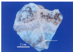
15. 縞状石英脈の割れ目を白色石英が充填している(矢印部)。縞状石英脈は裂罅に沿って1センチ程上下方向に変位している。
