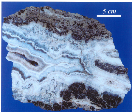
4. 対称縞状構造の発達した石英脈試料（切断面）。3号脈30mL富鉱部より採取。一際銀黒に富んだ試料である。銀黒およびスメクタイト/緑泥石混合層粘土鉱物部（淡緑-茶褐色部）を切って、白色、青灰色および茶褐色石英が成長した。
