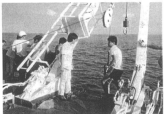
写真12 フィリピン鉱山局の「エクプローラー」船上でのピストンコアリング。
