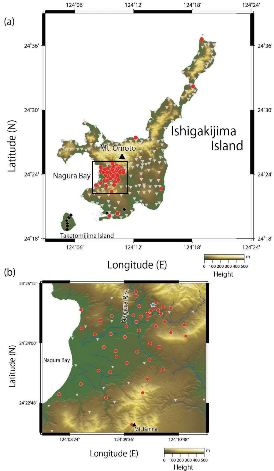
第1図 石垣島における重力測定点(a)および、名蔵川流域における重力測定点(b)の分布。本調査における相対重力測定点を赤丸、絶対重力測定点を青星で示す。既存の重力測定点のうち本多ほか(2012)を灰色三角、駒澤(2013)による測定点を黒菱形で示す。図中の背景の地形図は「国土地理院基盤地図情報(数値地形モデル)5 mメッシュ(標高)」を使用し、河川の位置は「国土数値情報河川データ」を使用した。
