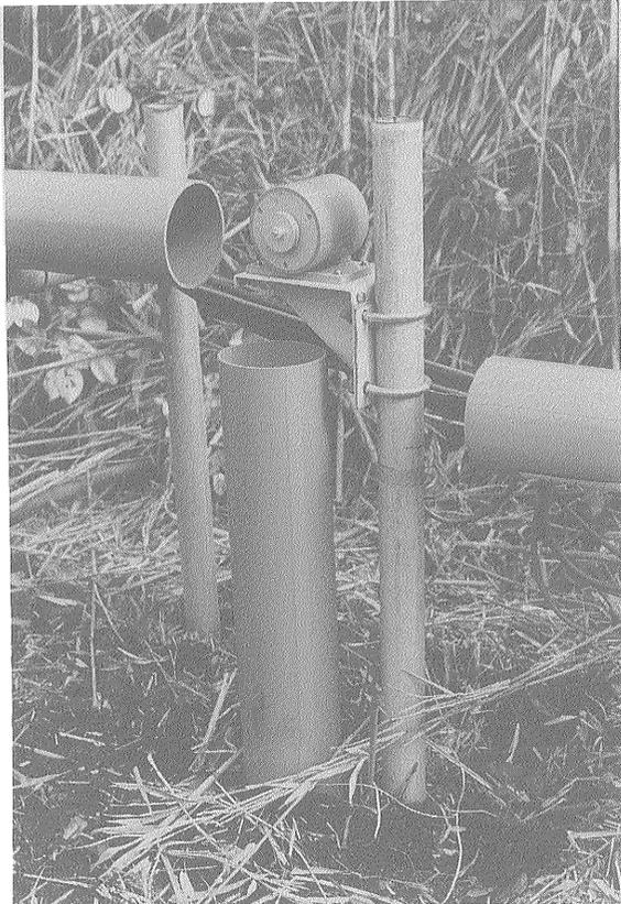
第4図 電気式伸縮計の移動計部分
