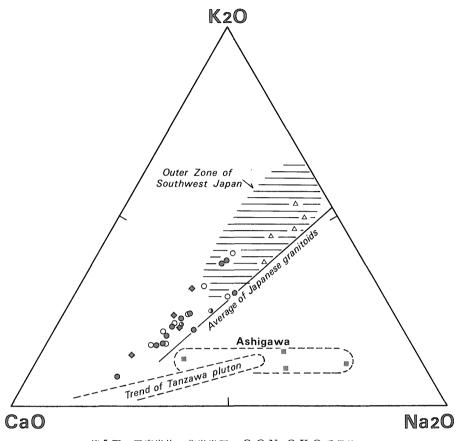
第5図 甲府岩体の花崗岩類の CaO-Na<sub>2</sub>O-K<sub>2</sub>O 重量比
