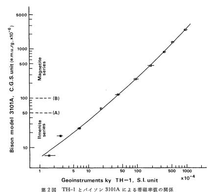
A と B はそれぞれ Ishmara (1979)・石原ら(1981)によるチタン鉄鉱系と磁鉄鉱系の境界
