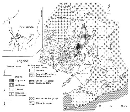
第1図 甲府岩体附近の地質 主に山梨県地質図(1970)による Fig. 1 Geologic map of the Kofu granitic complex.
