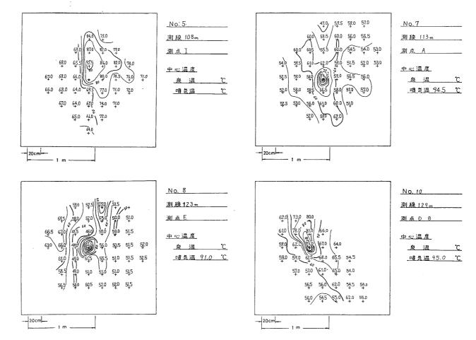
第5図-1 噴気孔周辺の岩盤壁面温度
