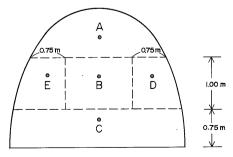
第8図 隧道断面内での通気観測点の位置
