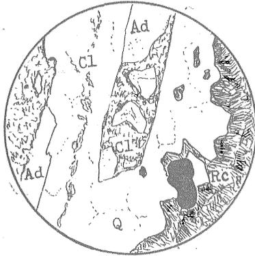
Ad: 氷長石 Cl: 緑泥石-氷長石化した母岩片, Q: 石英, Rc: 亜マンガン鉱。
