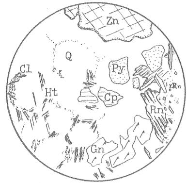
Rn: パラ輝石, r.Rn: 鉛・亜鉛-石英相に交代され残つたパラ輝石, Zn: 閃亜鉛鉱, Cp: 黄銅鉱, Gn: 方鉛鉱, Py: 黄鉄鉱, Ht: しばしば磁鉄鉱化している赤鉄鉱, Cl: 緑泥石, Q: 石英
