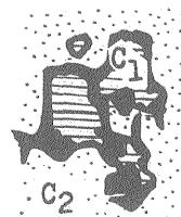
C 1 : 比較的大晶の辰砂 黒色部: 細粒石英 C 2 : 細粒辰砂 第 15 図 ×120
