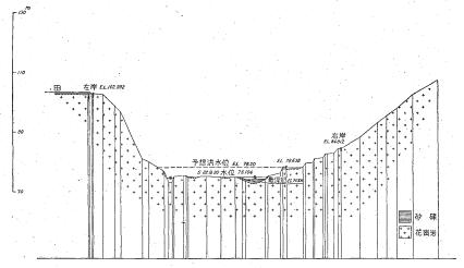
第7図 野津原地点調整ダム地点地質横断面図
