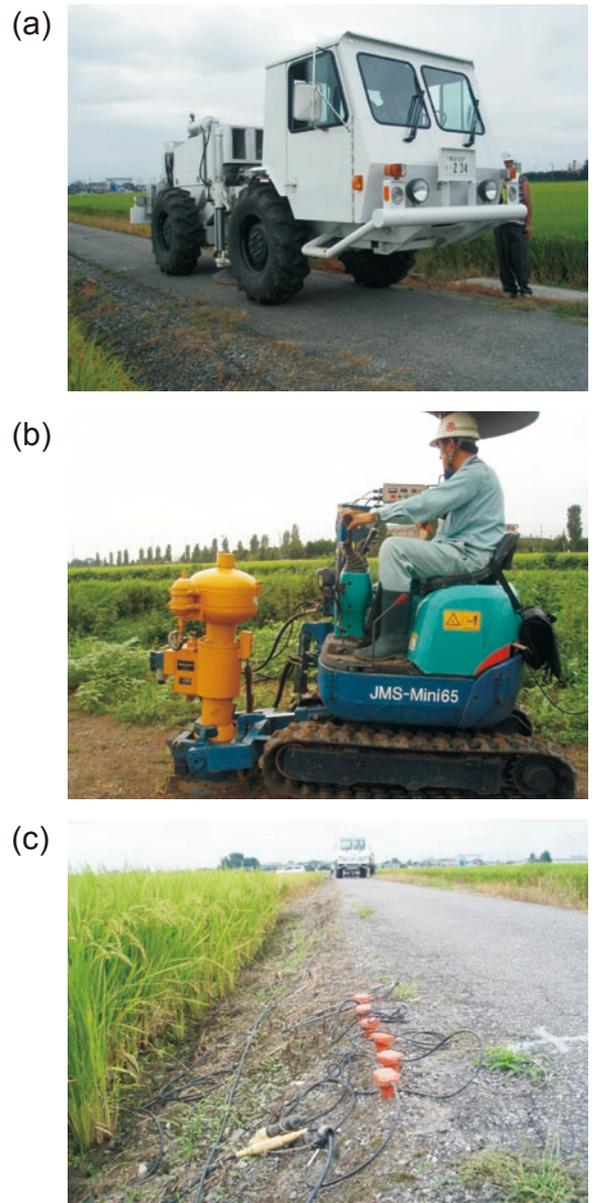
第4図. 調査機器. (a) 震源装置 (EnviroVib), (b) 震源装置 (Mini Impactor), (c) 受振器の設置状況.
