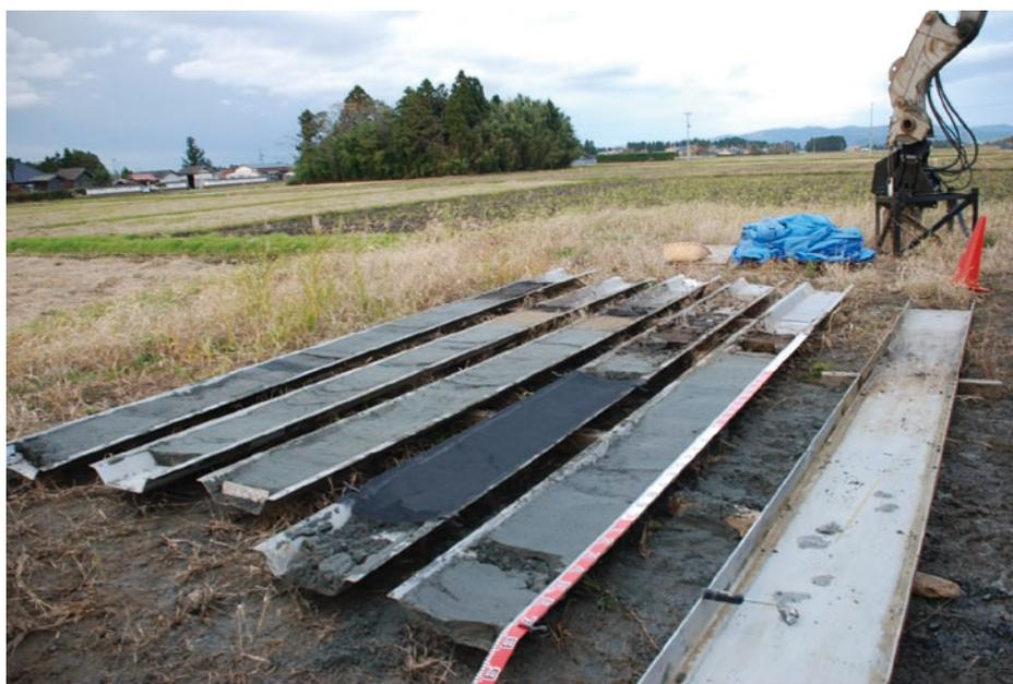
第2図. ジオスライサー調査の様子. 写真上: ジオスライサー掘削作業の様子.
