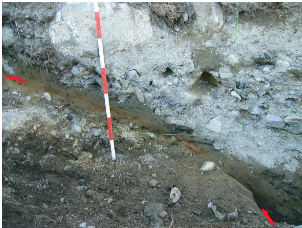
第13図. S2トレンチ北面撓曲部周辺の写真. 矢印は撓曲したスコリア層を示す. Fig. 13. Photo around a flexure on the north wall of the S2 trench. Arrows indicate a folded scoria layer.
