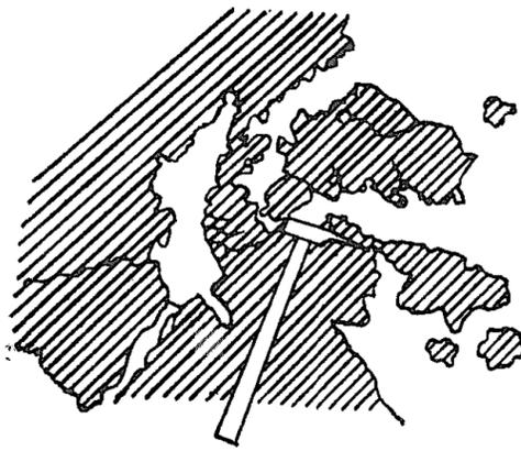
b) 乱堆積の説明図 (ハッチの部分は泥岩, 白の部分は礫岩)
