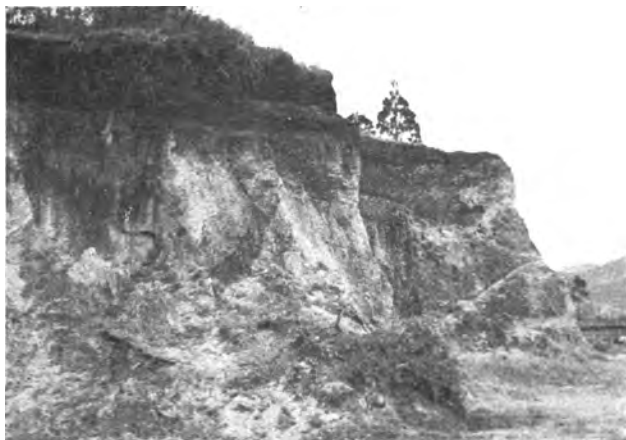
図版 16 飯肥東部に露出するシラス灰石層のシラスの部分 こゝではシラスが採取されて、附近の水田地の埋立に利用されている。上部の黒い部分はローム層
