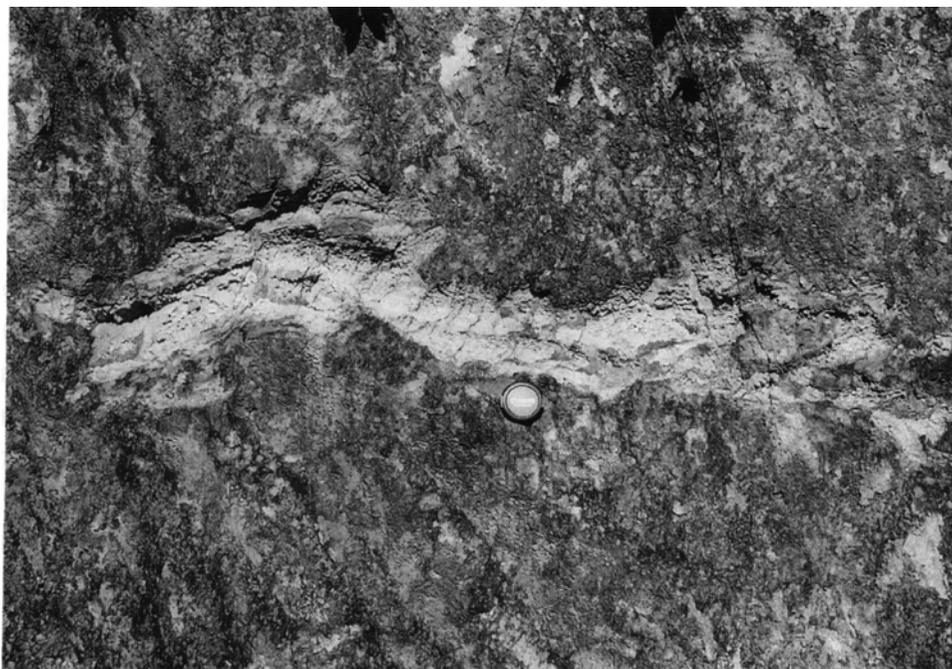
第51図 三瓶火砕流堆積物中の泥岩岩片 大田市島井町新田. レンズキャップの直径は約6cm
