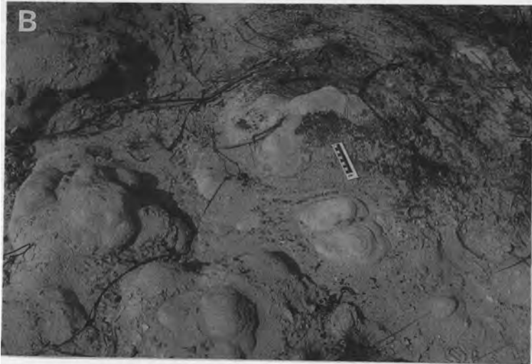
第50図 凝灰岩層の崩壊及び粘土化（地点：38，付図参照）
